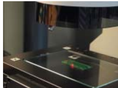
Lichtpunkt zur Anzeige der aktuellen Messposition (bei Tischbewegung kurzzeitig aktiviert)
